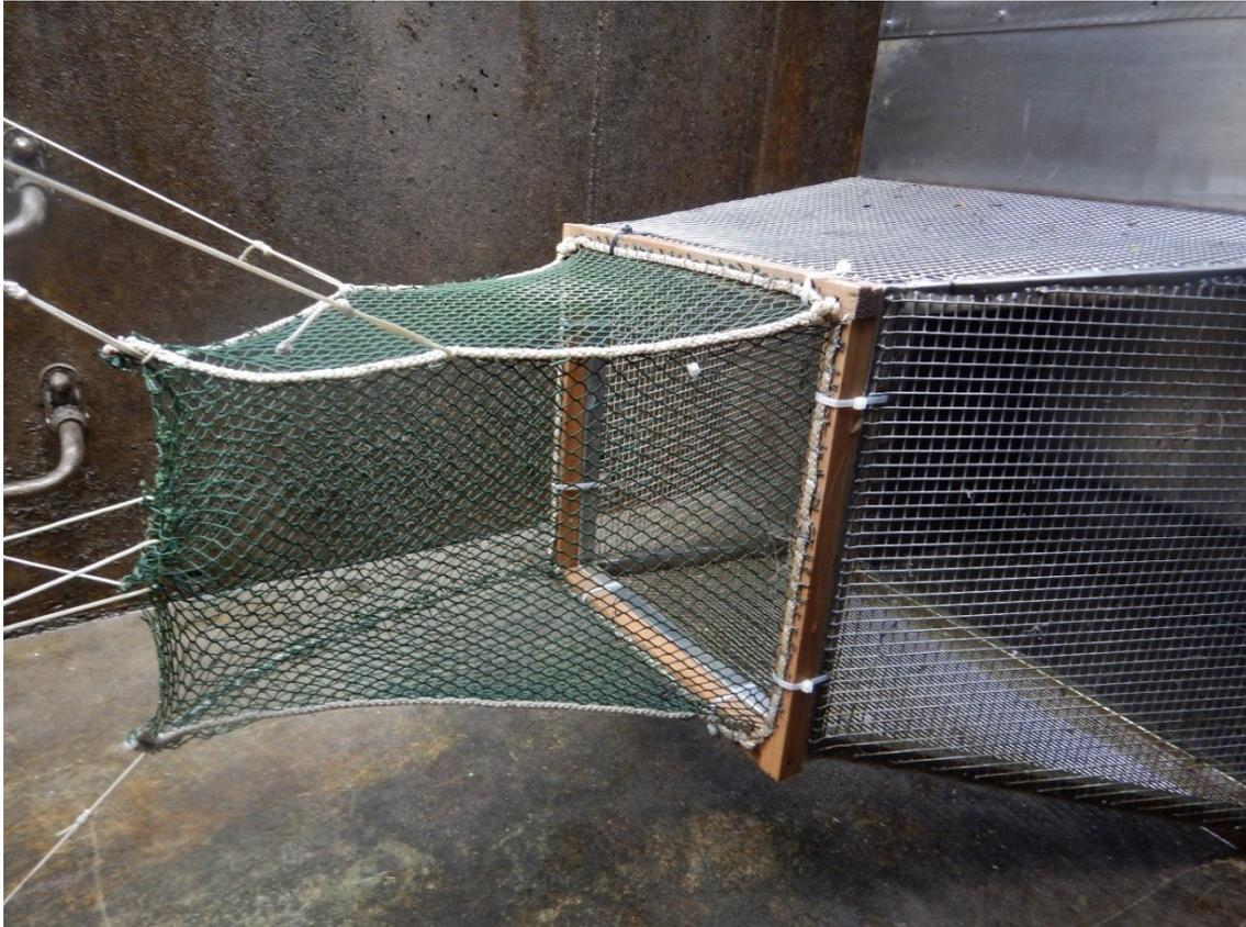
**Abbildung 8:** Die Netzkehle wird mit einem Rahmen am Metall befestigt und mit Schnüren nach vorne aufgespannt
