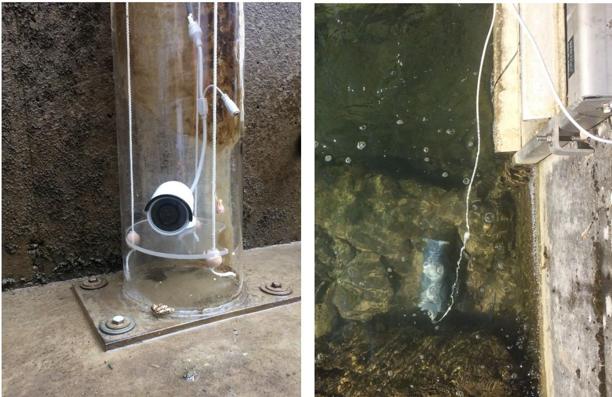
Abbildung 11: Links: Kamera im Zählbecken. Rechts: Kamera in Unterwassergehäuse am Eingang zum Zählbecken.
